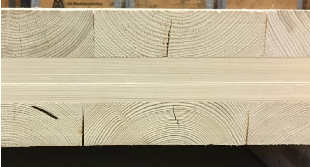
Figur 1 Tvärsnitt på bärdäck av KL-trä
