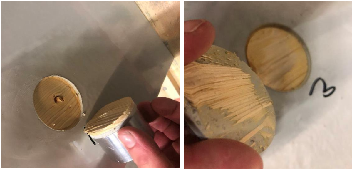
Figur 8 Brottbilder efter dragprovning med högsta (t v) respektive lägsta (t h) resultat
